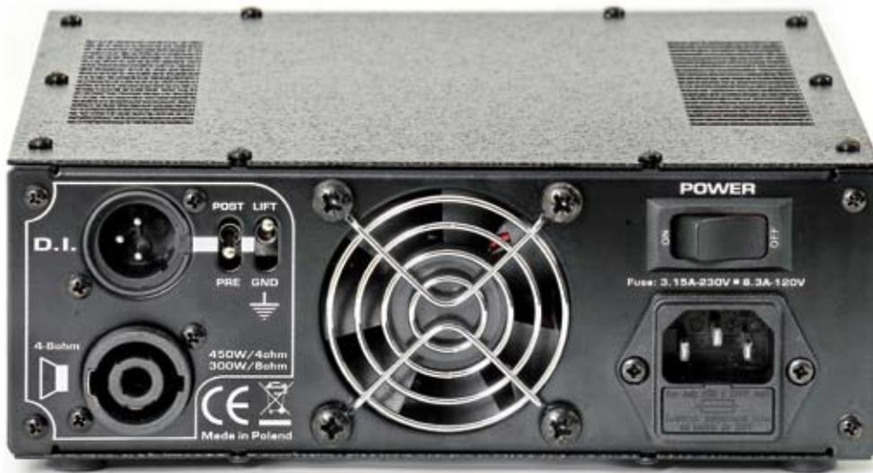
En el panel trasero hay una salida directa XLR, con sus conmutadores Post/Pre y Lift/Gnd.
